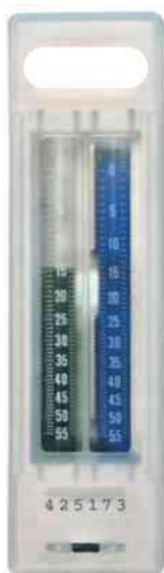
Obr. 3.2 Indikátor na principu odparu – dvouampulový
